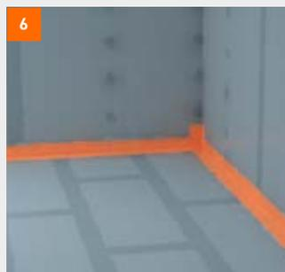
6 Bei Verwendung von Powerpanel H<sub>2</sub>O im Bereich A0: **fermacell** Abdichtungssystem nur im Randbereich
