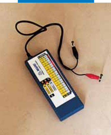
Feuchtigkeitsbestimmung mittels speziellem MAPEI-Messgerät
