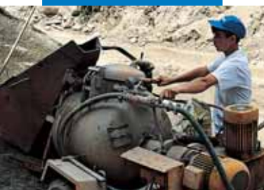
Fördertechnik: Estrichmischer mit Pumpe
