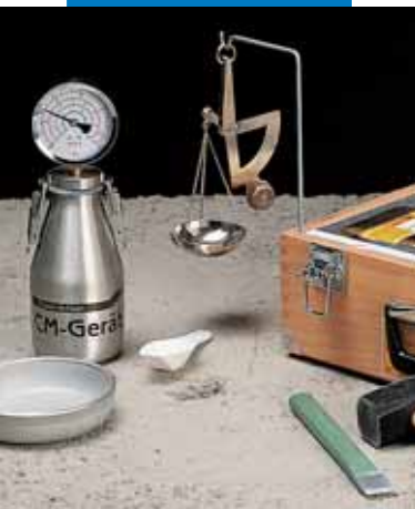
Feuchtigkeitsmessung nach dem CM-Verfahren
